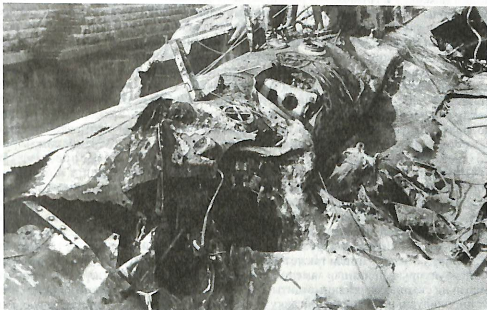
Разрушения в средней части надстройки L-55
